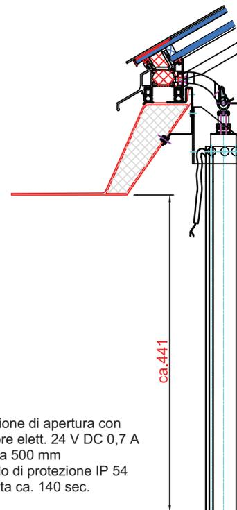
Versione di apertura con motore elett. 24 V DC 0,7 A
