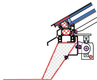
Variante di apertura con motore a catena 230V
