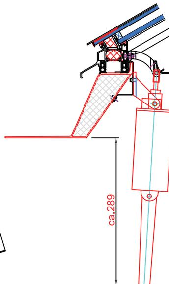
Variante di apertura con motore elett. 230 V/50Hz
