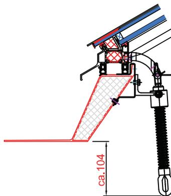
Variante di apertura con dispositivo di azionamento a vite adatto solo per piccole dimensioni corsa max. 300 N
