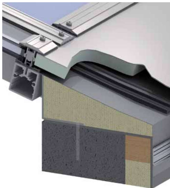
Montaggio su cordolo in cemento
