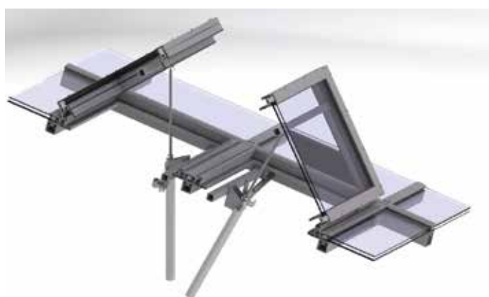
DOPPIO BATTENTE SU COPERTURA PIANA
