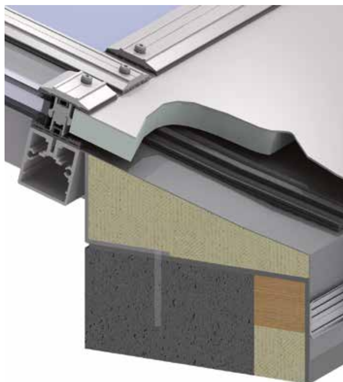
MONTAGGIO SU CORDOLO IN CEMENTO
