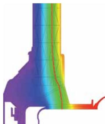
Le ottime tecniche di termoisolamento dell'intera struttura assicurano i migliori coefficienti di trasmittanza termica  $U_w$  per un sistema di lucernari continui omologato a livello europeo. Le caratteristiche di efficienza energetica sono testate e certificate a norma ETAG 010, a comprova del flusso di calore omogeneo nell'ambito del sistema di lucernari continui.
