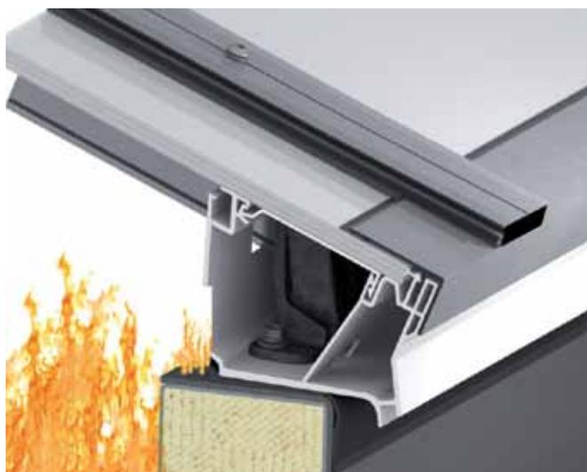
Il manto del tetto brucia a mò di "miccia" in direzione della superficie esterna del tetto.
