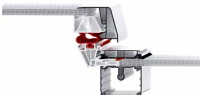
Schwallwasserlippe und integrierte Ballondichtung
