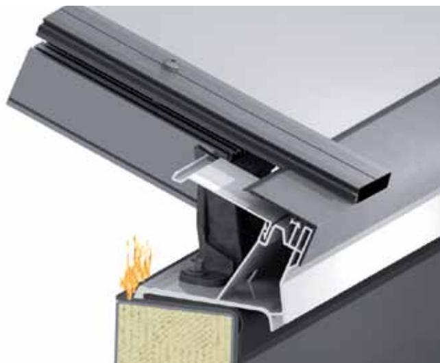
Il sistema LDS si appoggia sopra il manto del tetto che sta bruciando e provoca lo spegnimento delle fiamme. Ciò impedisce un'eventuale propagazione delle fiamme fino alla superficie esterna del tetto.
