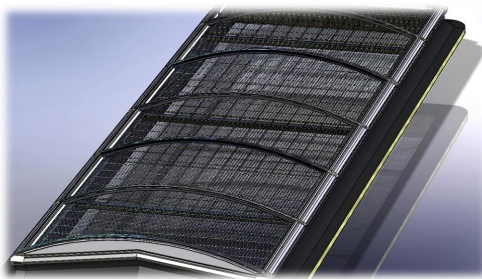
La rete antivolatile viene appoggiata sulla rete anticaduta e fissata con delle fasc stringitubo.
